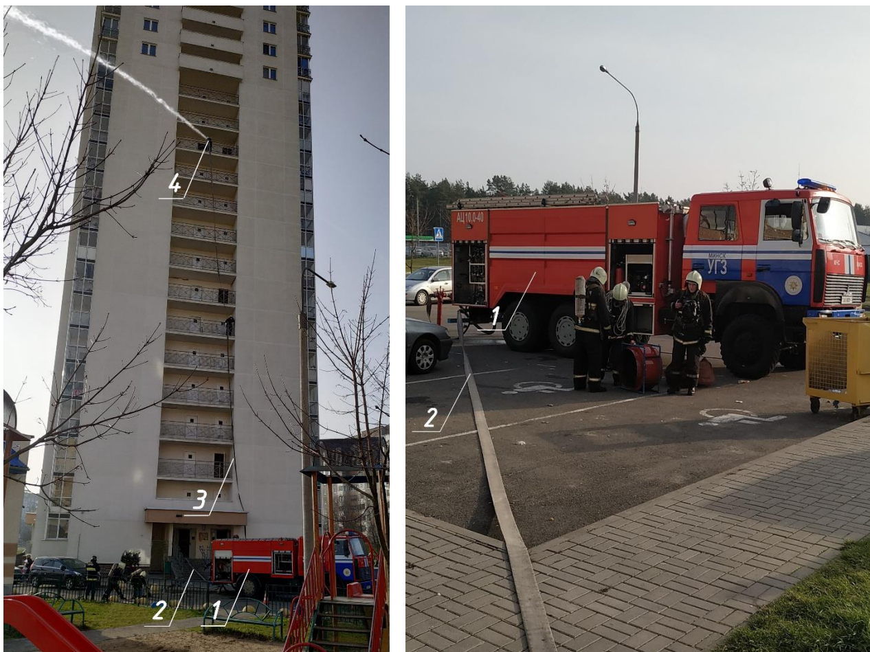
1 – автоцистерна с насосом НЦПН 40/100; 2 – магистральная линия из напорных рукавов диаметром d = 77 мм; 3 – магистральная линия из напорных рукавов диаметром d = 66 мм; 4 – СПРУК 50/0,7 «Викинг»
