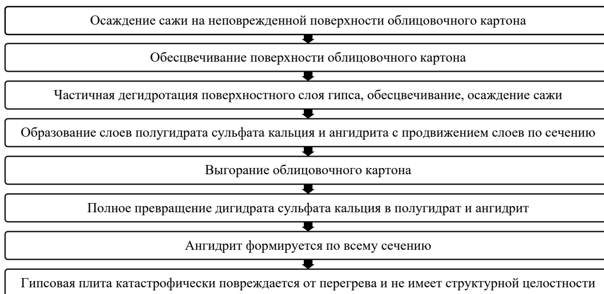
Рисунок 1. – Стадии повреждения гипсовой плиты вследствие воздействия на нее высоких температур [6]
