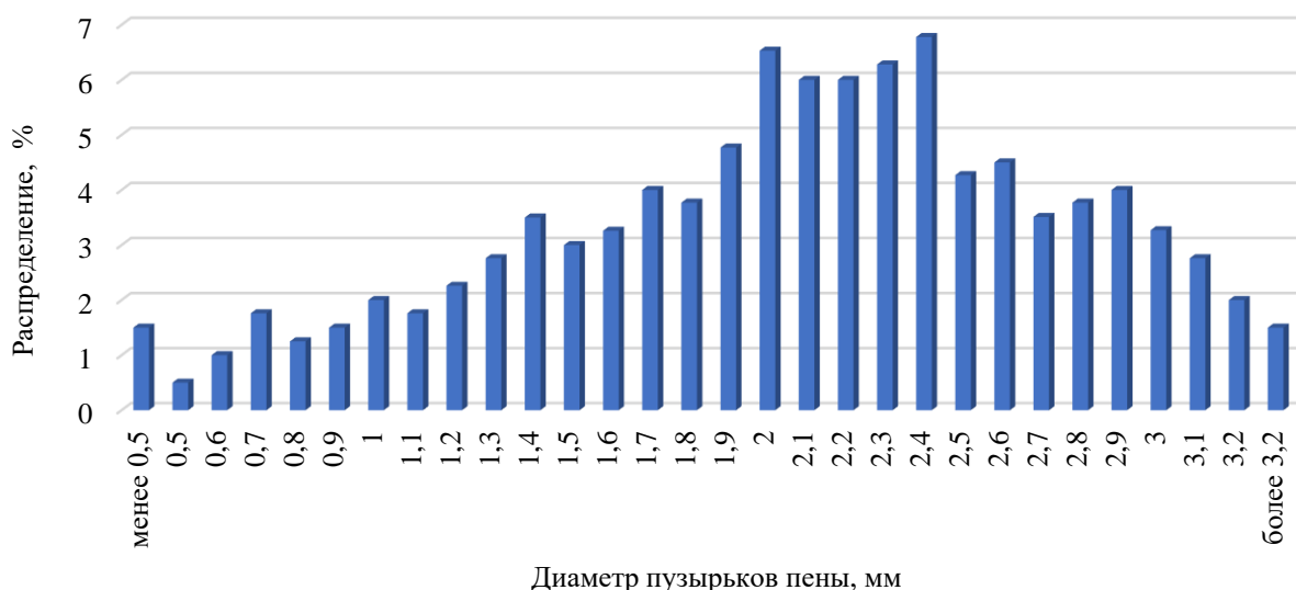
Рисунок 5. – Гистограмма распределения пузырьков пены для случая с наибольшим отклонением экспериментального результата от теоретического (при размерах ячейки сетки 3,2 \times 3,2 мм и расстоянии l = 50 мм)
