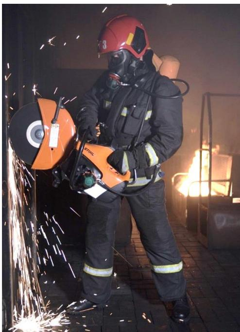
Рисунок 6. – Вскрытие металлической конструкции бензорезом в непригодной для дыхания среде
