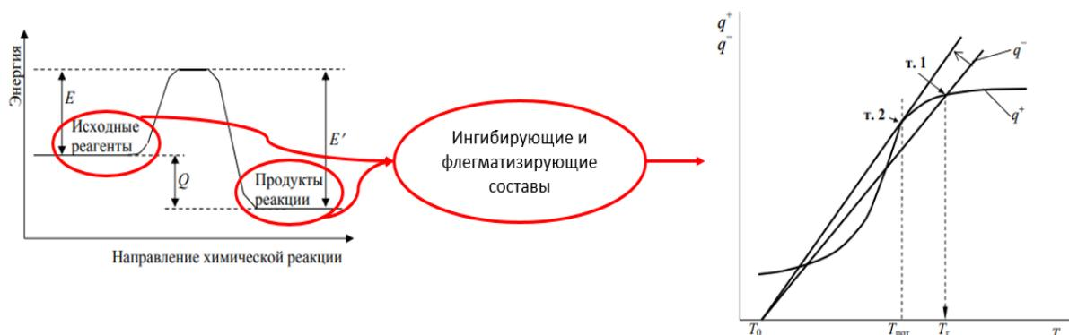
$E$  – энергия активации;  $Q$  – тепловой эффект реакции;  $E'$  – конечное энергетическое состояние системы,  $q^+$  – количество выделяющегося тепла;  $q^-$  – количество отводимого тепла;  $T_0$  – начальная температура;  $T_r$  – температура горения (т. 1);  $T_{пот}$  – температура потухания (т. 2)
