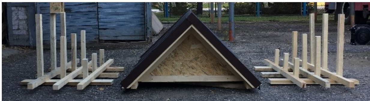
Рисунок 4. – Модельный фрагмент двускатной кровли
