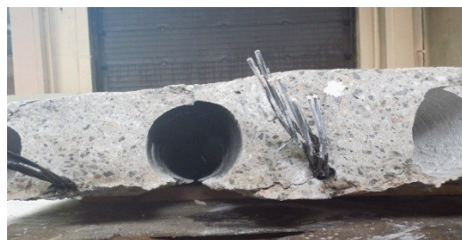
б) разрушение защитного слоя экспериментальных образцов
