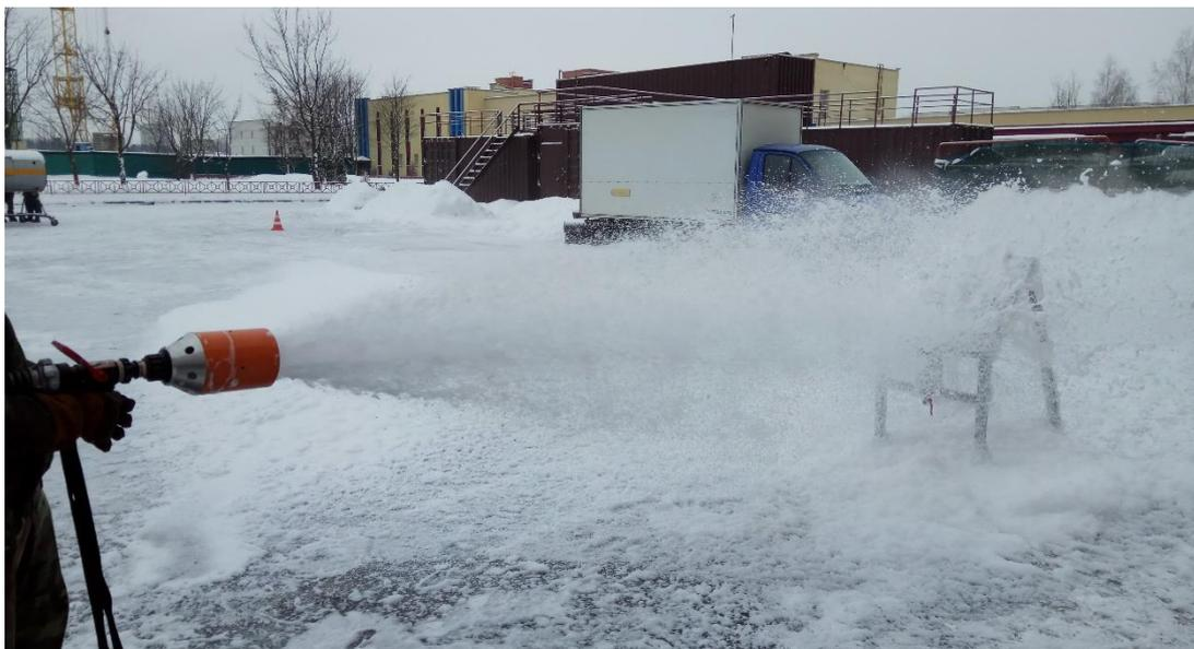
Рисунок 7. – Исследование кратности пены пеногенератора
