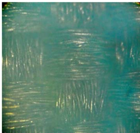
Рисунок 4. – Микрофотография поверхности химически осажденного на поверхность полиэфирной ткани покрытия Ni-P
