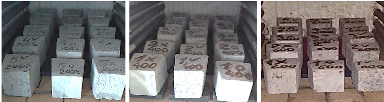
Рисунок 3. – Образцы после нагрева до 200, 400, 600 °С (слева направо)
