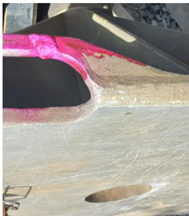
б – сварной шов рукоятки
