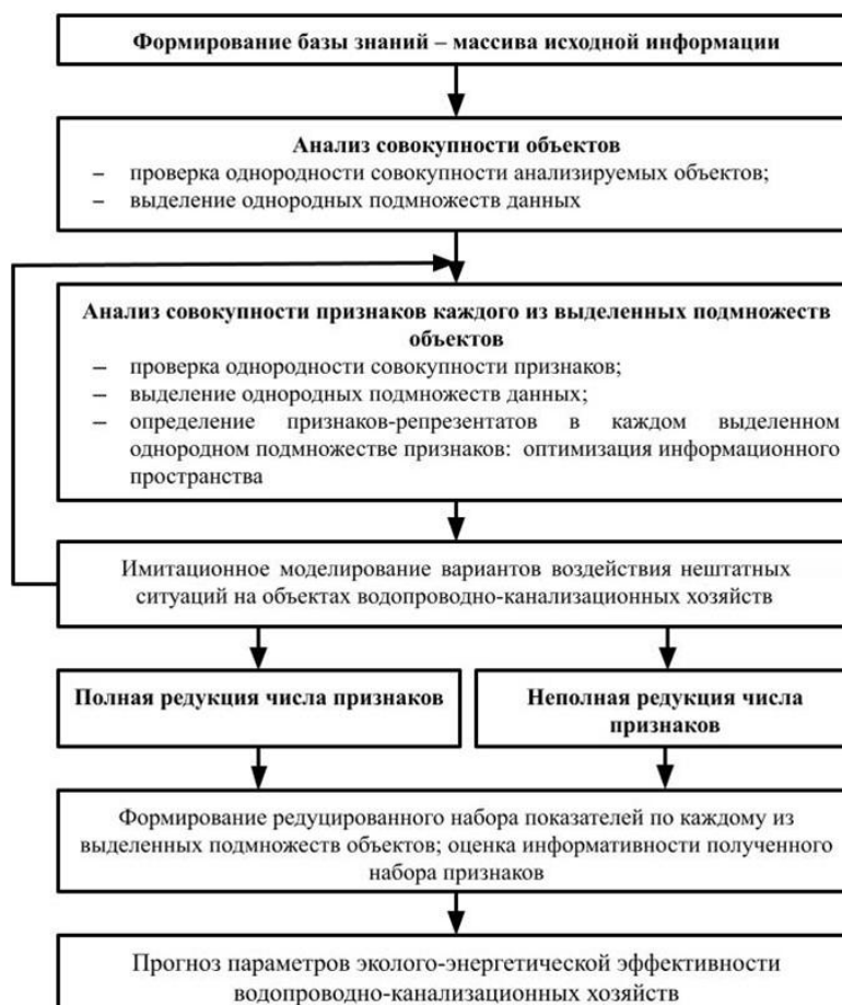
Рисунок 2. – Последовательность создания и использования компьютерно-интегрированного комплекса мониторинга и прогнозирования рисков чрезвычайных ситуаций на объектах коммунально-промышленного водоотведения
