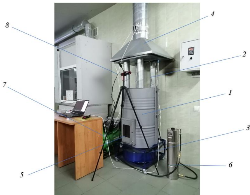
1 – бокс для испытаний (камера сгорания); 2 – питающий трубопровод с электромагнитным клапаном для подачи огнетушащего вещества с установленным на конце регулируемым распылителем; 3 – поддон; 4 – вентиляционные отверстия с воздуховодами; 5 – дверца со смотровым окном для установки внутри бокса модельного очага пожара; 6 – емкость для ОТВ; 7 – компрессор с манометром; 8 – видеочкамера
