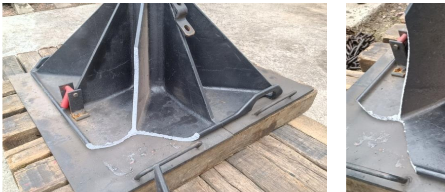
Рисунок 3. – Разрушение пирамидальной опорной подставки крана серии ЕДК-2000
