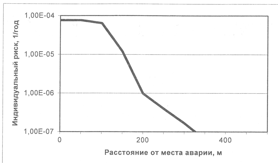
Рис. 6 Суммарный индивидуальный риск при разгерметизации трубопровода с СУГ
