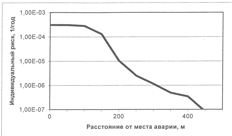
Рис. 4. Суммарный индивидуальный риск при разгерметизации железнодорожной цистерны с СУГ
