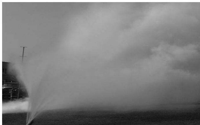
Рисунок 4 – Влияние водяной завесы на распределение потока примеси
