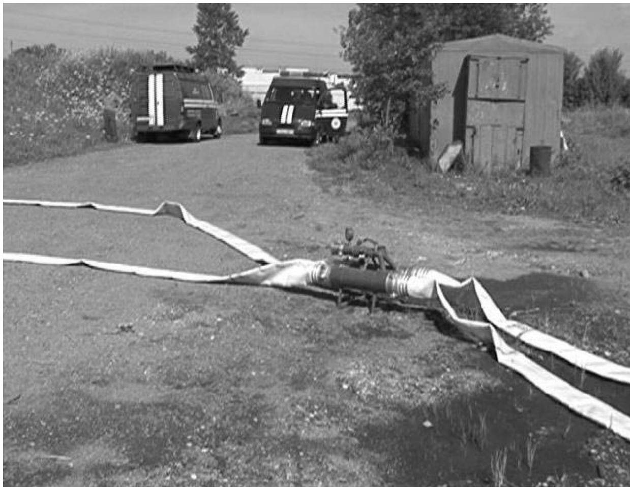
Рисунок 9 – Испытание работоспособности дозатора-пеносмесителя
