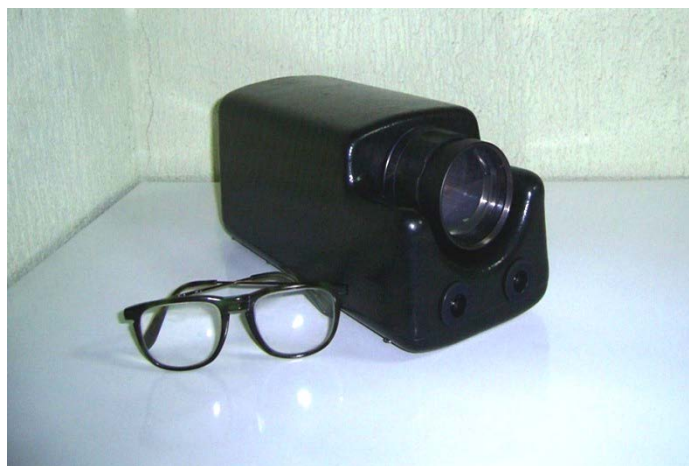
Рисунок 2 – Внешний вид экспериментального образца оптико-электронной системы улучшения видимости в дыму
