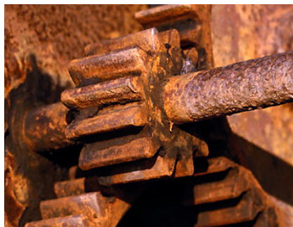
Зубчатая передача лебедки
