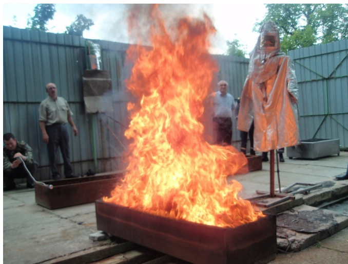
Рисунок 6 – Испытания теплозащитной одежды с использованием приборов ВТП -01 и СТП-02
