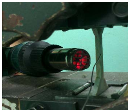
Рисунок 12 – Общий вид прочностных испытаний при повышенной температуре
