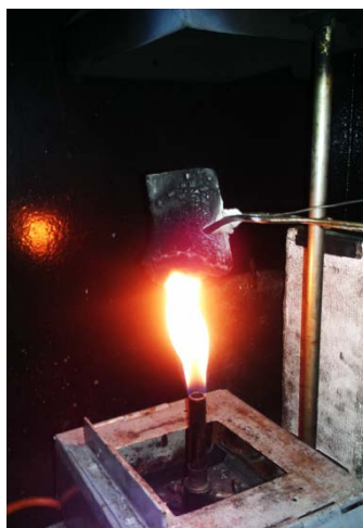
Рисунок 4 – Общий вид экспериментальных исследований по ГОСТ 16363
