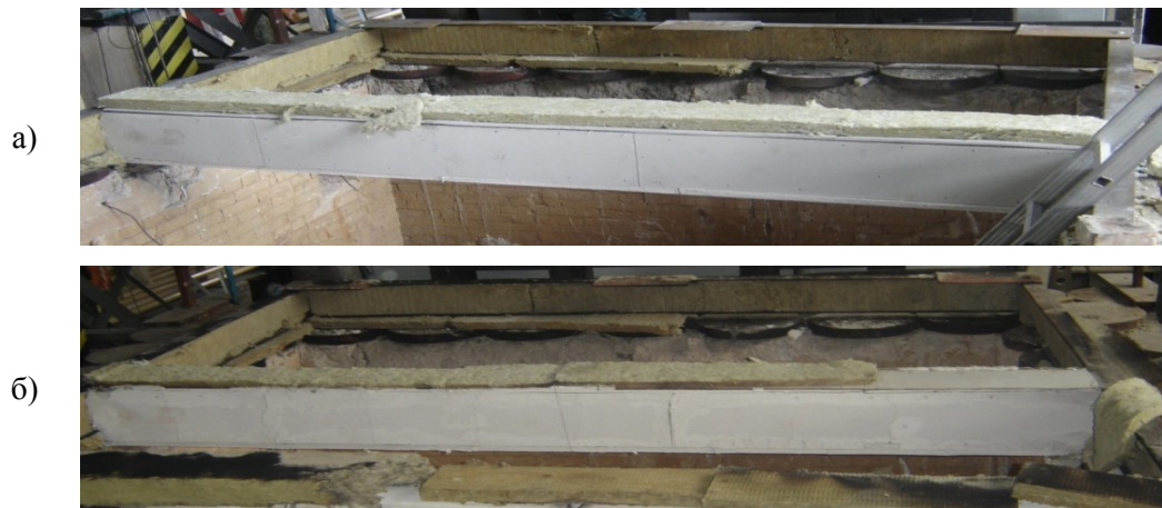
Рисунок 1 – Композитная балка до испытаний (а) после испытаний (б)
