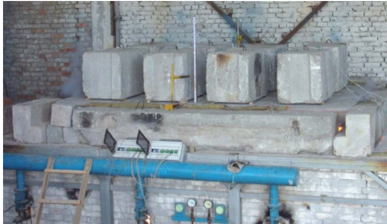
Рисунок 3 – Вид образцов на печи под нагрузкой
