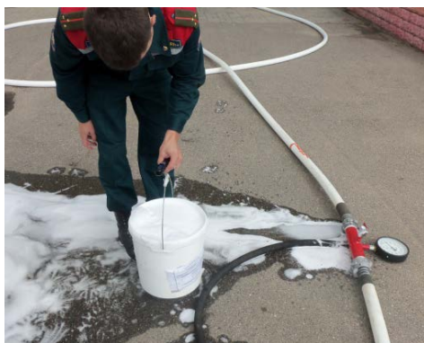
Рисунок 8 – Отбор пены для определения кратности
