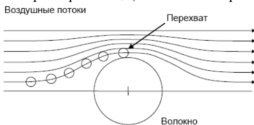
Рисунок 1 – Схема фильтрации аэрозольных частиц методом перехвата
