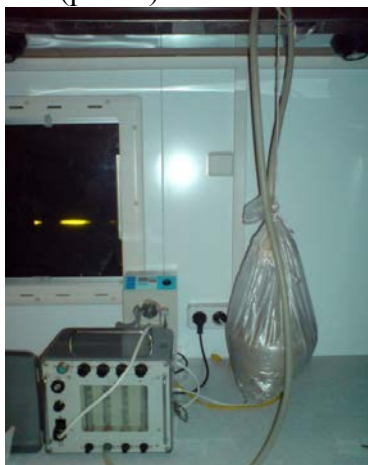
Рисунок 5 – Исследование защитных свойств фильтра противогаза ЗМ 6035
