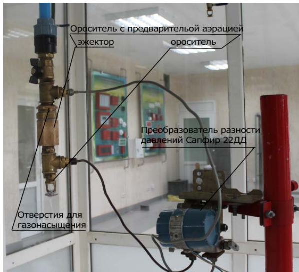
Рисунок 2 – Фотография преобразователя разности давлений Сапфир-22ДД (2440)
