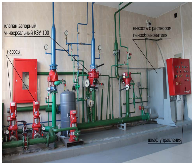
Рисунок 1 – Фотография лабораторной установки для проведения исследований
