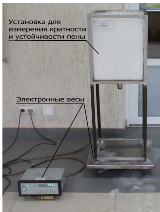
Рисунок 4 – Фотография установки для измерения кратности и устойчивости пены
