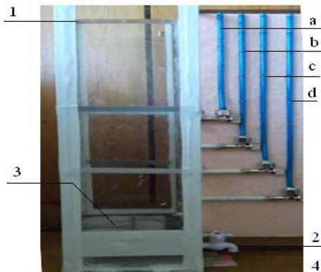
1 – вертикальная колонка прямоугольного сечения; мерный сосуд; 2 – кран для регулирования фильтрационного расхода; 3 – металлическая решетка; 4 – дно экспериментальной установки; a, b, c, d – пьезометры
