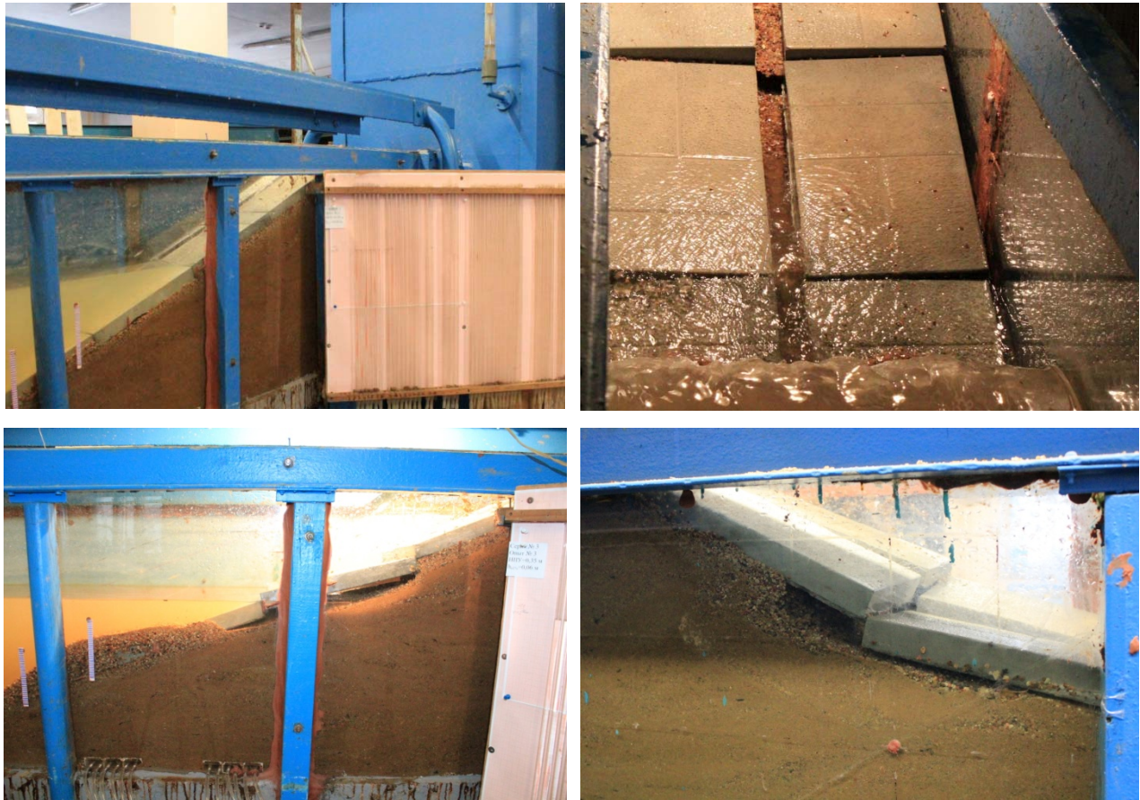
Рисунок 6 – Результат волнового воздействия на верховой откос и разрушение крепления при H = 0,35 м и h_b = 0,06 м
