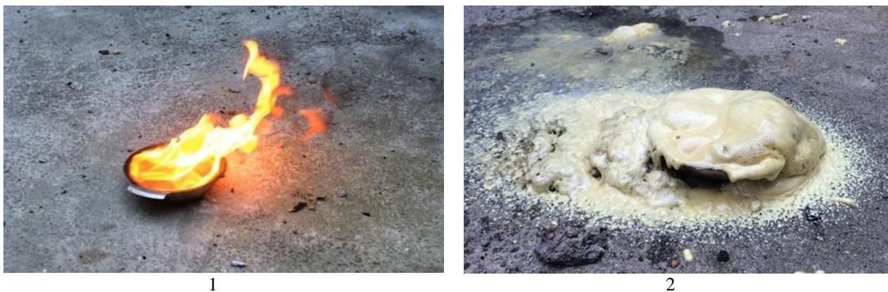
**Рисунок 1 – Тушение антипирированным пенополиуретаном лабораторного очага пожара класса В: внешний вид лабораторного очага: 1 – перед началом тушения, 2 – после тушения**
