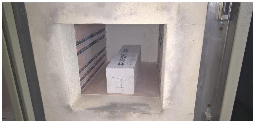
Рисунок 1 – Вид экспериментального образца в муфельной печи
