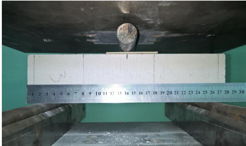
Рисунок 4 – Общий вид образцов при испытании на растяжение при изгибе
