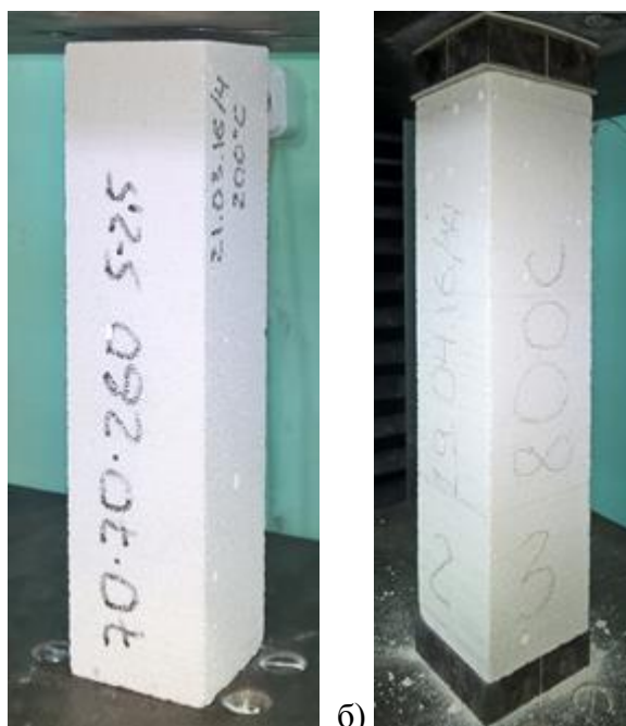
Рисунок 3 – Общий вид образцов при испытании на прочность при сжатии
