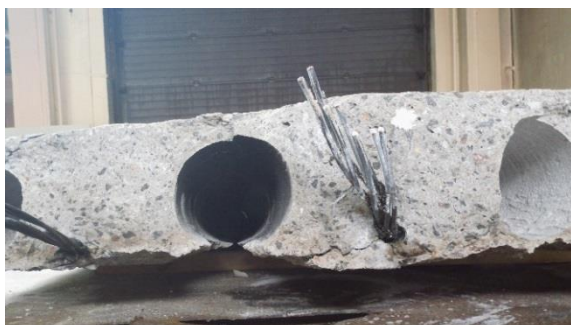
Рисунок 1 – Хрупкое разрушение защитного слоя бетона экспериментальных образцов
