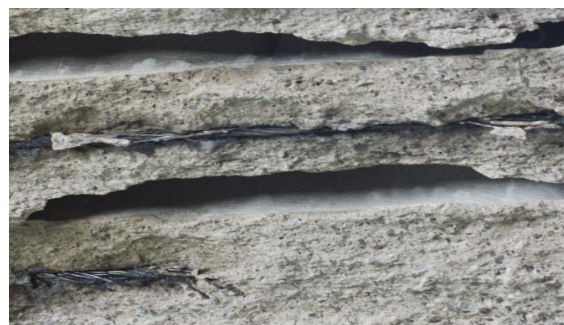
Рисунок 1 – Хрупкое разрушение защитного слоя бетона экспериментальных образцов
