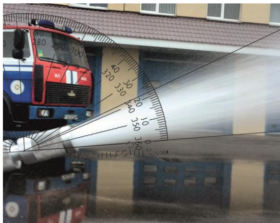
Рисунок 3 – Измерение угла факела струи
