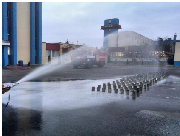
Рисунок 4 – Определение средней интенсивности орошения и эффективной дальности струи
